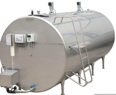
OPCIONAL: Medidor electrónico de capacidad FONTSERE de gran precisión (Error<0,2%). Se trata de un novedoso sistema con un flotador alimentario de acero inoxidable que genera una señal 4-20 mA hacia el sistema de indicación que correctamente tratado nos permite visualizar en todo momento el volumen de producto contenido en el depósito.
